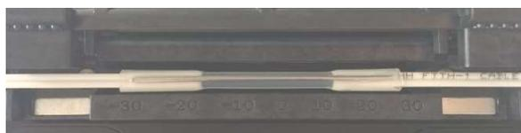
Рисунок 2-21 Размещение волокна с защитной втулкой
