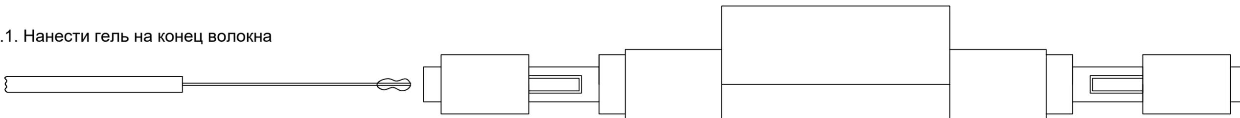
П.2.2. Центрируя, во избежание повреждения скола, ввести волокно в соединитель. Проверить, вошло ли волокно до упора небольшим дополнительным усилием.
